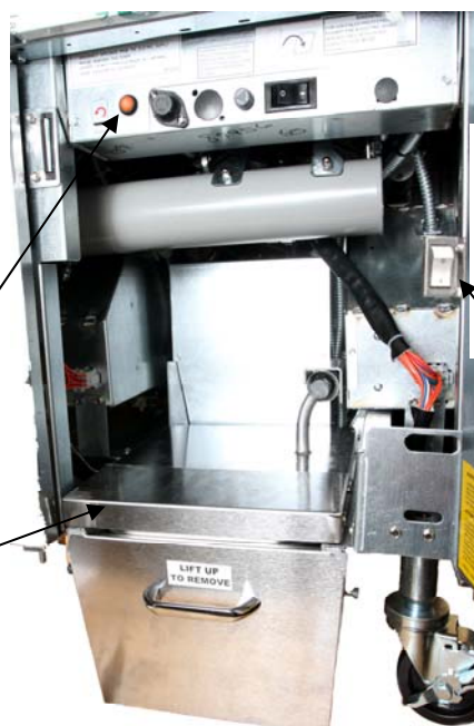
Figure 3 : Fixez les connecteurs blancs à deux broches et branchez le connecteur noir au coffret de prise de courant ainsi que montré.
